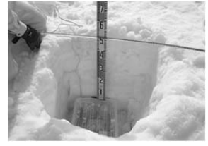
写真-4 送信部雪中埋設状況
