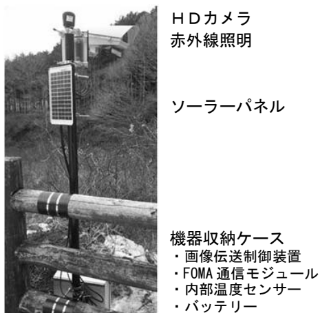
図4 インターバルカメラの設置状況
