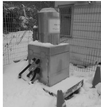
図5 自動降灰・降雨量計設置状況 (2015.2.19 スノータウン・イエティ)
