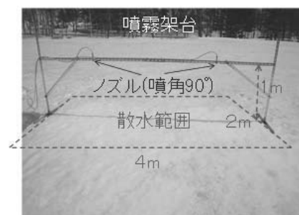
図 1 積雪への散水状況
