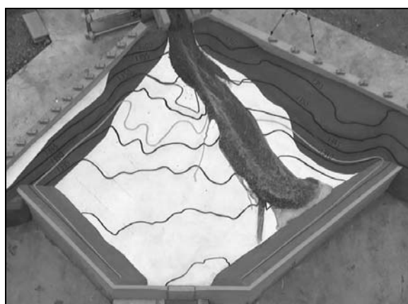
写真 3 現況勾配 1/7 時の土石流の流向
