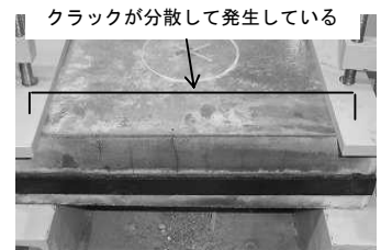
写真-2 クラック状況
