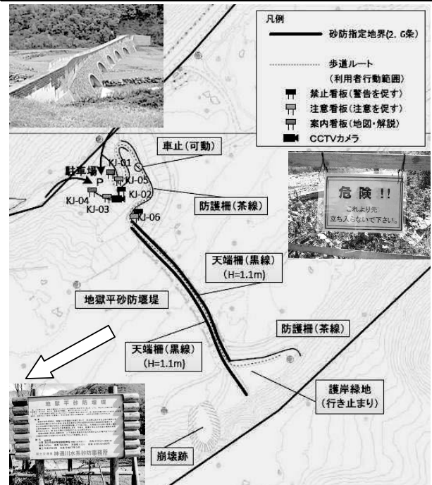
図 2 安全利用に関する看板等設置状況図(地獄平砂防堰堤の例)
