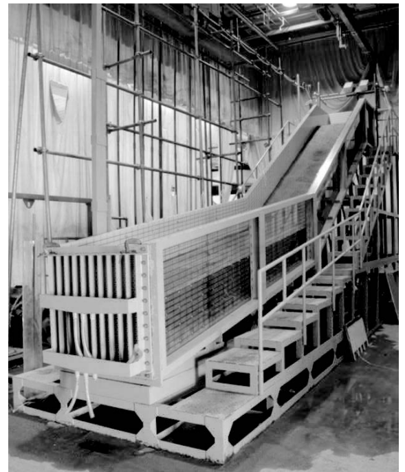
写真 斜面崩壊実験に使用した大型模型
