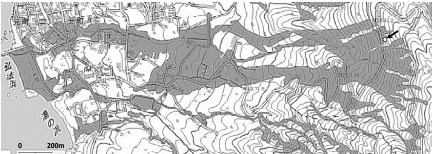
図-1 土壌試料採取地点（図中の矢印で示した位置） 国土地理院災害情報共有マップに加筆。影の部分は崩壊・土砂流出・堆積域を示す
