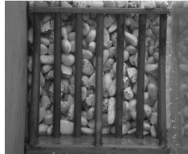
写真-2 礫捕捉状況(正面)
