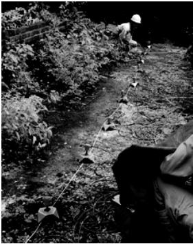
図-1 弾性波探査（改良型）の概念図（左）および天端における発振・受振状況（右）
