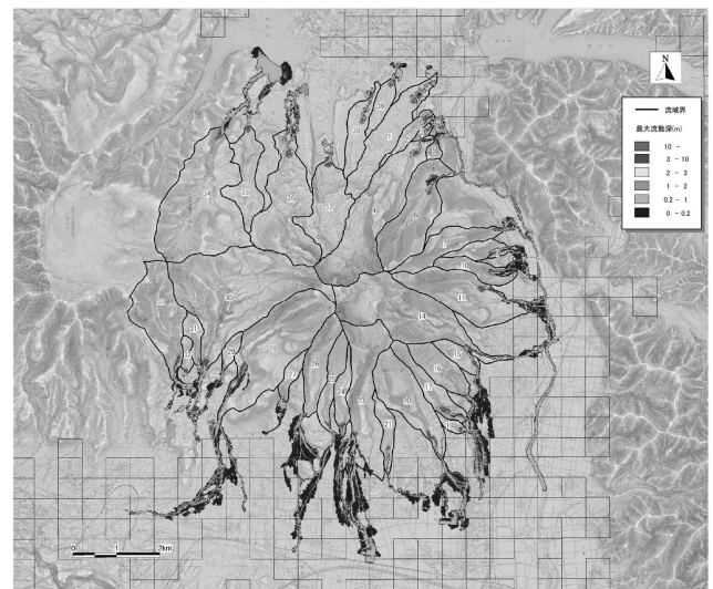
図-3 降灰後の土石流の想定到達範囲（最大流動深）（水蒸気噴火とマグマ噴火：100年超過確率）
