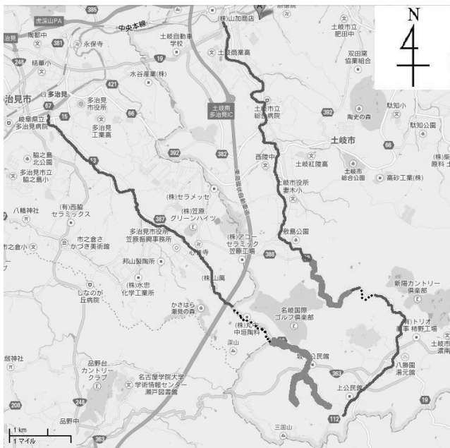
図3. 妻木川(右)と笠原川(左)のStep-Poolの空間分布(太線: Step-Poolあり, 細線: Step-Poolなし, 点線: 不明)
