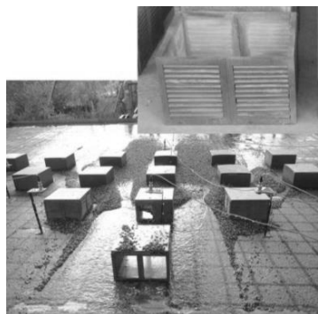
図1：破壊される家屋模型(右上:拡大図、下:破壊状況)
