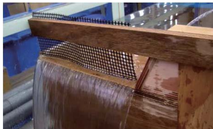
写真1 a) 堰堤模型の越流部
