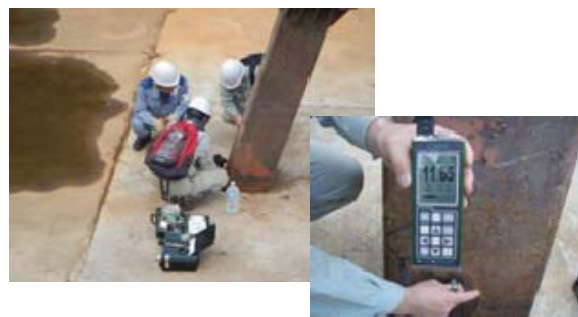
板厚測定状況
