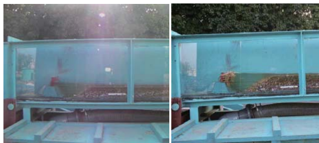
ケース1 ケース3 写真-1 堆砂肩の形成状況
