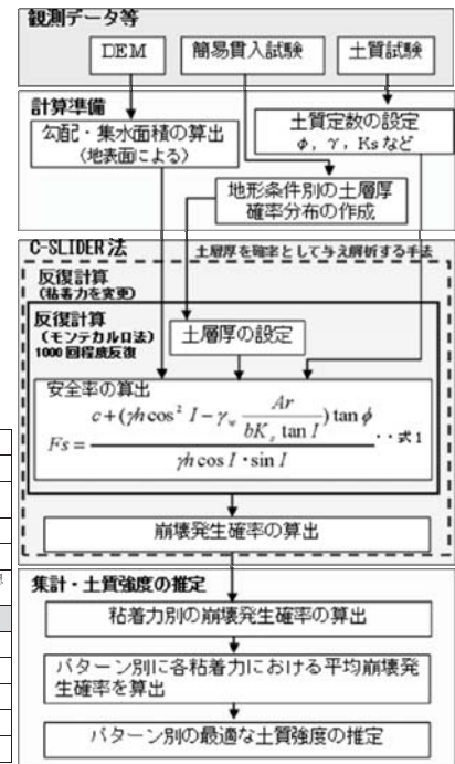
図 4：数値計算による土質強度の算出フロー
