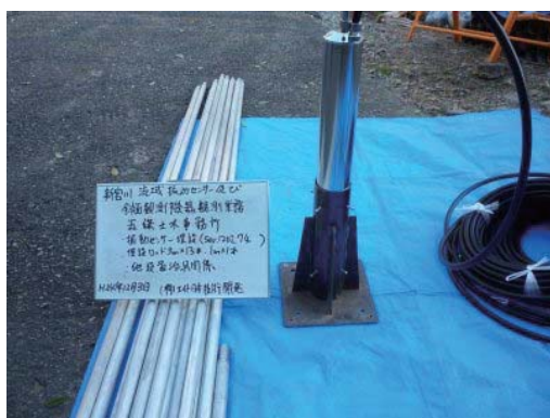
写真-1 観測局の振動センサー(速度計 VSE-355JE)
