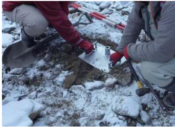
写真-3 計測手順（左から②RI 計器設置箇所の整地、③線源ロッドの差込孔の開孔、④RI 計器の設置）
