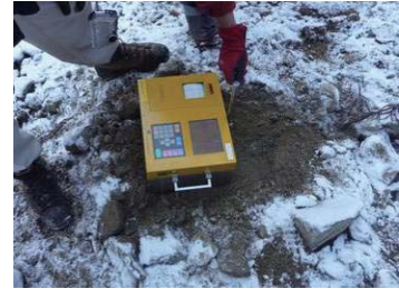
写真-3 計測手順（左から②RI 計器設置箇所の整地、③線源ロッドの差込孔の開孔、④RI 計器の設置）
