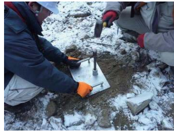
写真-3 計測手順（左から②RI 計器設置箇所の整地、③線源ロッドの差込孔の開孔、④RI 計器の設置）
