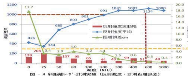
図-4 斜距離レーザー計測実験（反射強度・計測距離誤差）
