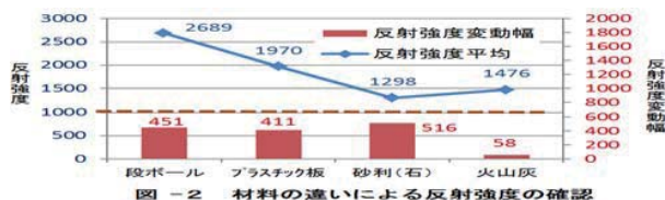
図-2 材料の違いによる反射強度の確認
