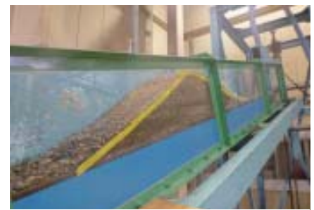
写真-1 実験水路と天然ダム case1
