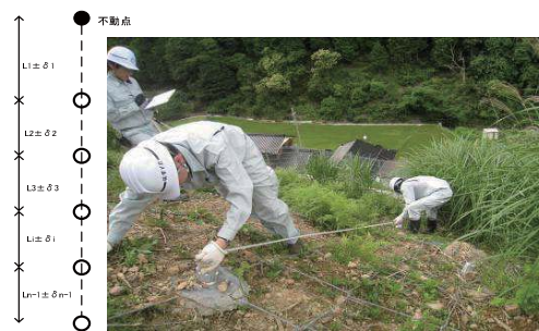
図2 管理基準軸の計測と簡易計測状況例
