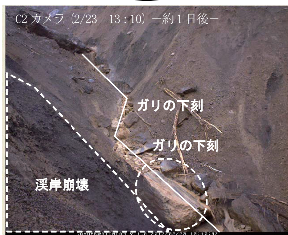
写真-1 ガリ侵食部の溪岸崩壊と下刻(定点写真)
