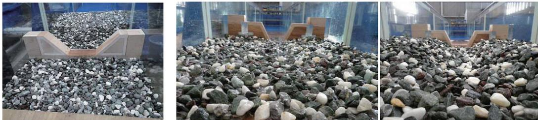
写真1 複断面型えん堤模型 写真2 広放物線形状の河床 Case A 写真3 複断面形状の河床 Case B
