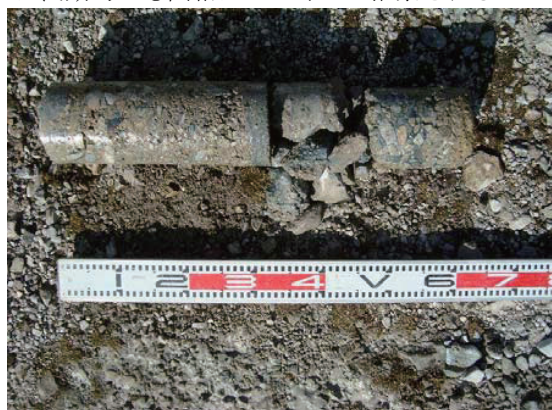
写真1 サンプルコア（トンネルズリ C=300）
