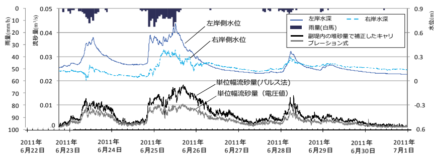
図-4 源太郎砂防堰堤における音圧・ハイドロフォンパルスと予測された単位幅流砂量の関係(2011年6月22日～30日出水)
