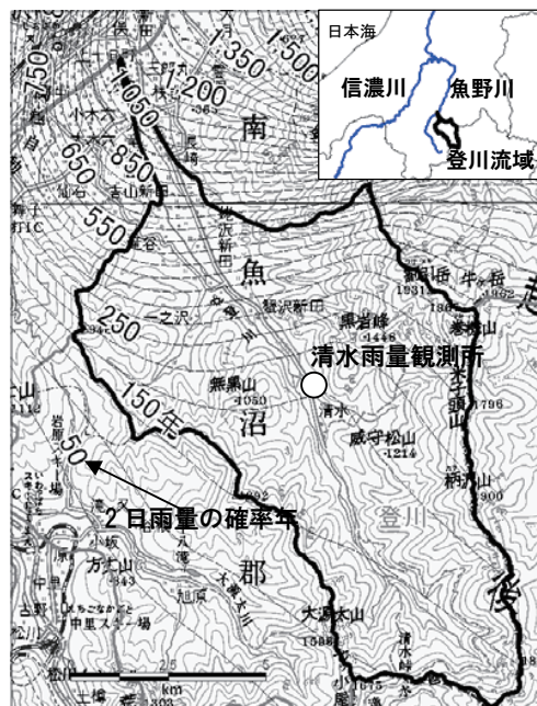
図 1 調査対象箇所と災害時の 2 日雨量の等確率雨量線
