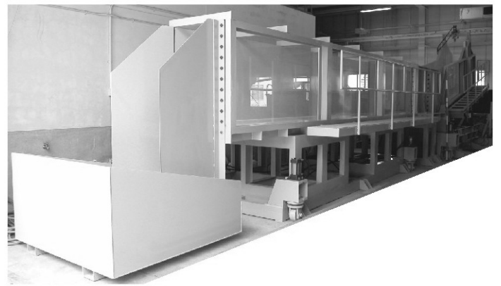
写真-1 土砂流下実験に使用した模型水路
