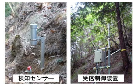
斜面崩壊検知センサーは、斜面の崩壊を検知する検知センサーと検知センサーからの信号を受信し、警報出力する受信制御装置から構成される
