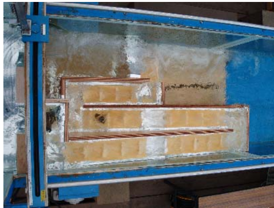
写真 3 模型実験で使用した提案魚道 (1/16.7 縮尺スケール)
