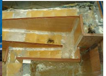
写真 3 模型実験で使用した提案魚道 (1/16.7 縮尺スケール)
