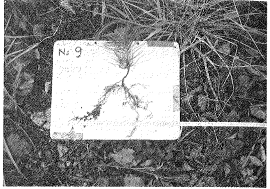
写真-2 根系伸長状況 クロマツ 種子吹付工 大畑沢 S 61.9
