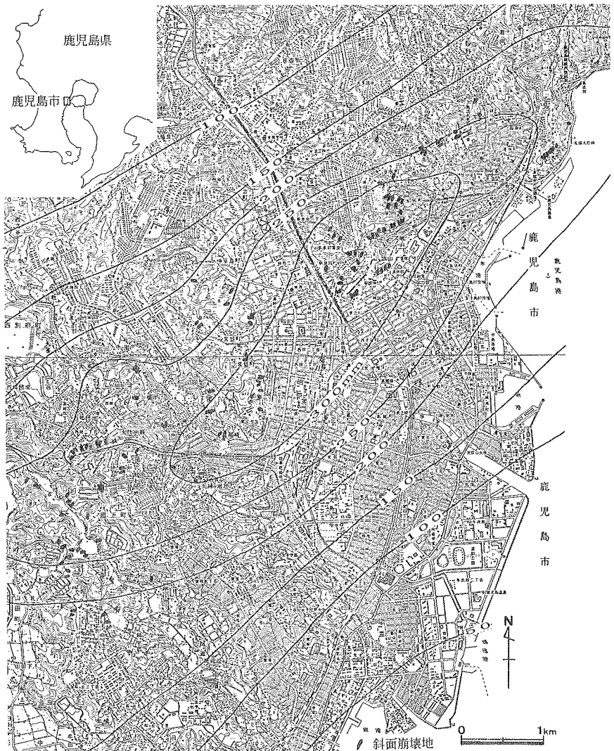
図-1 1986年7月10日集中豪雨による斜面崩壊地の分布 (等雨量線は鹿児島県土木部河川資料による)
