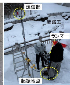
写真-1 無線式簡易振動センサの振動検知部及び送信部 写真-2 ランマーによる起振状況
