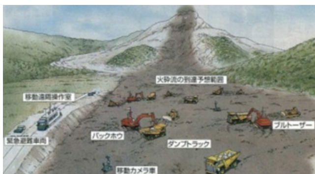
図 4-16 雲仙における無人化施工の概念図
