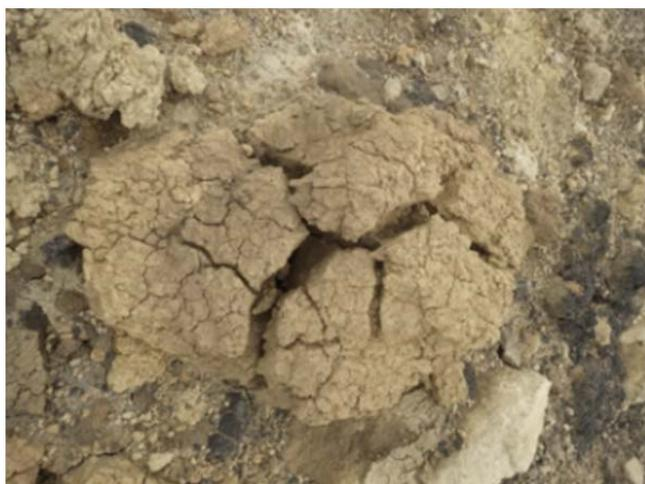
図-7.2.5.1 土塊の乾燥収縮によるひび割れ（2016年7月24日撮影）
