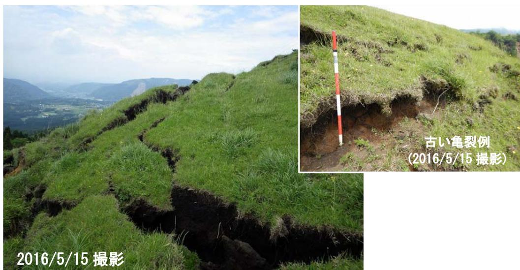
図-7.4.2.3 下方側崩壊地内の上部斜面に認められた新しい亀裂 (右上は古い亀裂例)
