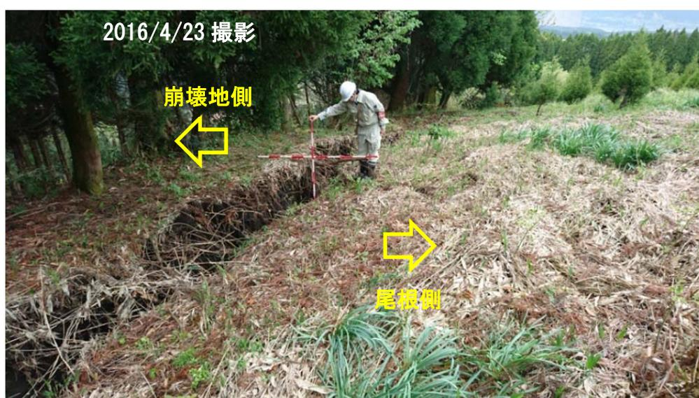
図-7.4.1.6 滑落崖上部の亀裂状況
