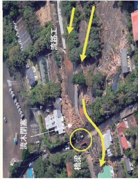
口絵写真一15 つばき小学校南側の橋梁の流木閉塞状況 (国際航業㈱・㈱パスコ撮影：2013年10月17日)
