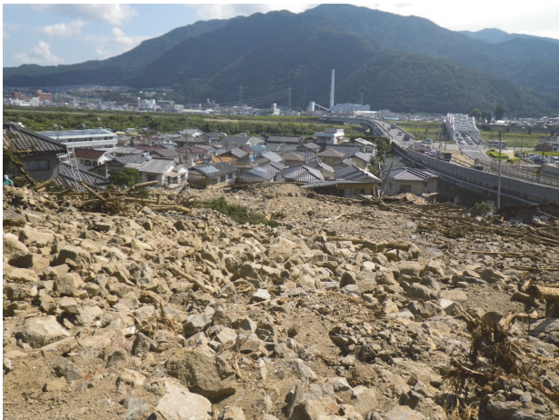
写真-15 太田川支川 71 の谷出口付近の氾濫状況 国道 54 号の盛土が土石流を規制している
