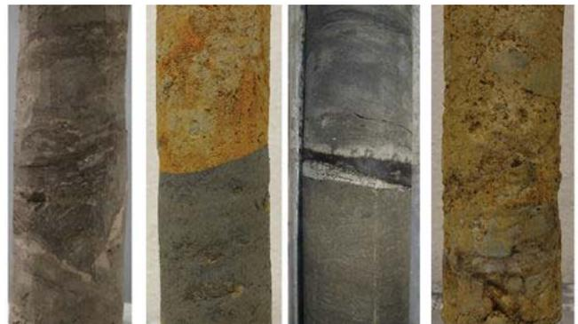
図-2 ボーリング調査で採取されたすべり面の事例
