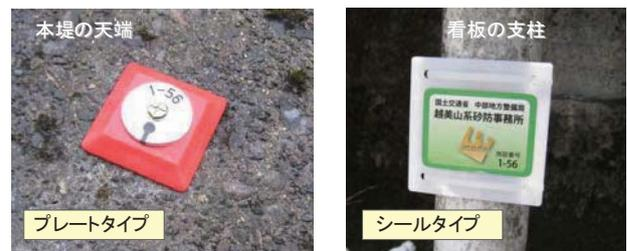
図2 ICタグの構成と設置写真
