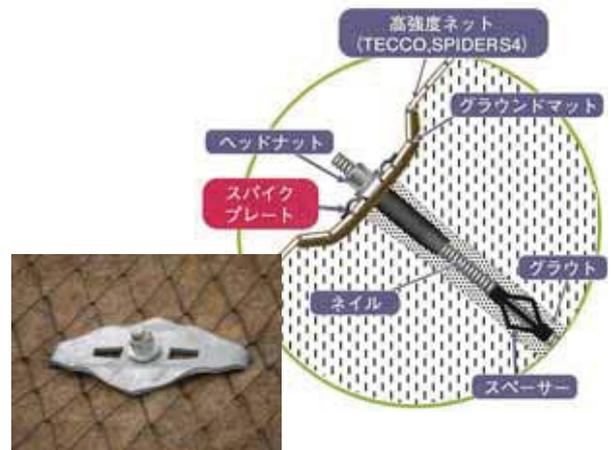
図-2 パワーネット工法の標準構造
