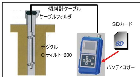
図-2 新型挿入式孔内傾斜計システム図
