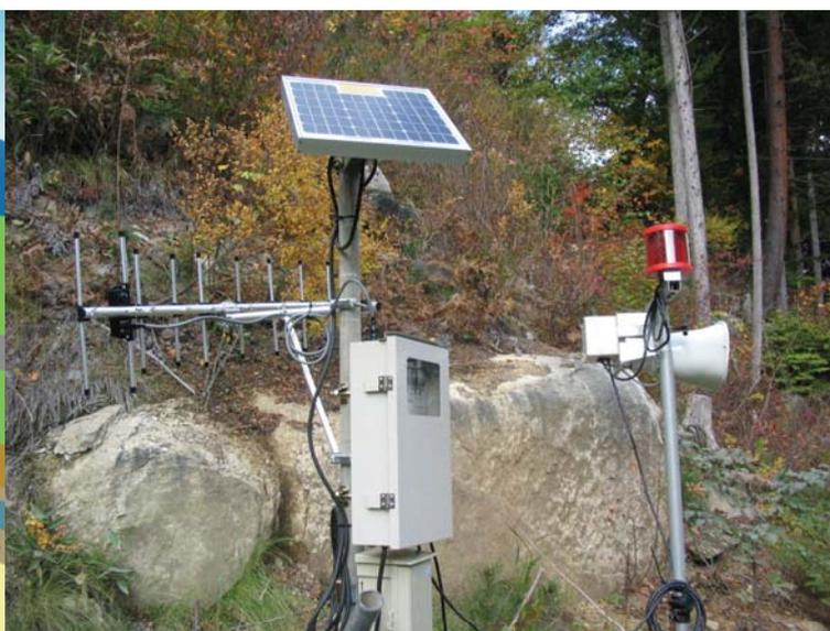
図-1 設置イメージ、受信器設置状況
