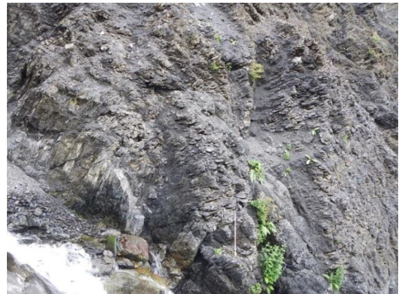
図－5 スレートのトップリング
