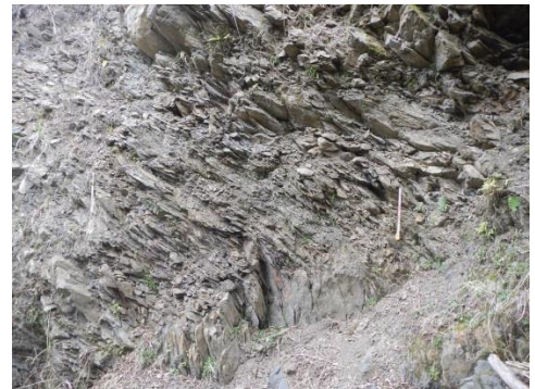
図-3 左岸に発達するスレートのトップリング
