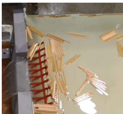
写真-4 CASE2～4 (平均捕捉率 81.1%) (模型 Ver. 1 ; オリジナル)
