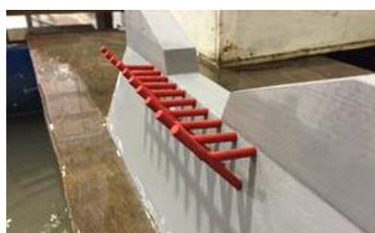
写真-2 流木捕捉工（サイド横材無し）
