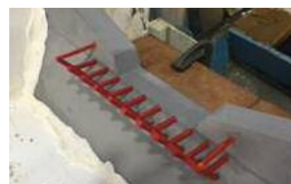
写真-3 流木捕捉工（サイド横材有）
