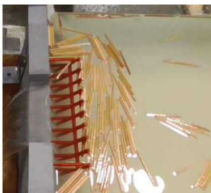
写真-5 CASE5～7 (平均捕捉率 98.5%) (模型 Ver. 2 ; サイド横材追加)
