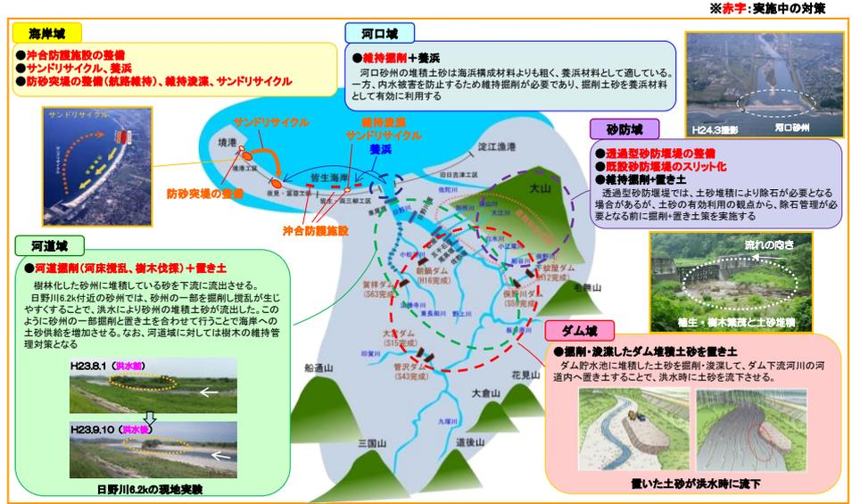
図-1 日野川流砂系の総合土砂管理計画の概要
