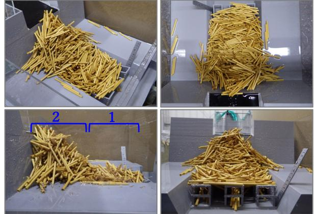
写真-3 流木捕捉状況（1013本捕捉後）
