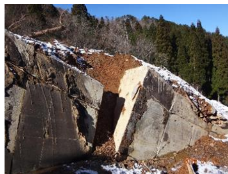
写真2 転倒ブロック側部の円弧状摩擦痕
