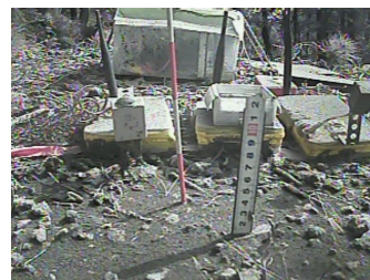
図4 インターバルカメラによる降灰状況の撮影結果の例(2018.3.14)
