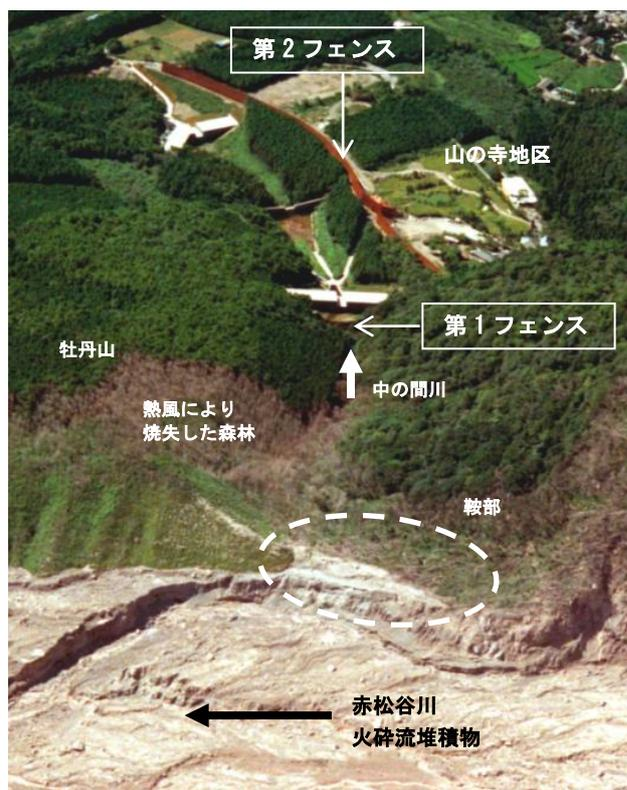
図-2 中の間川の熱風防護柵と山の寺地区<sup>1)</sup>
