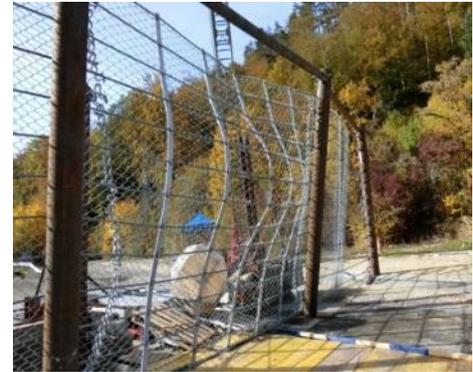
写真-4 実験後の試験体状況
