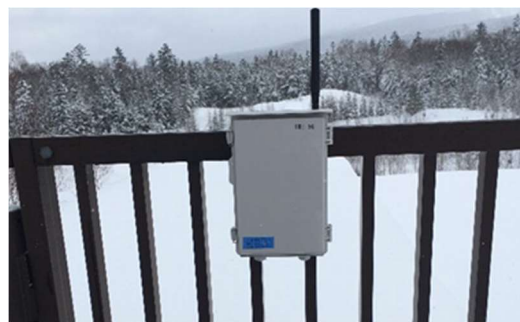
図-1 非接触火山泥流検知システム図
