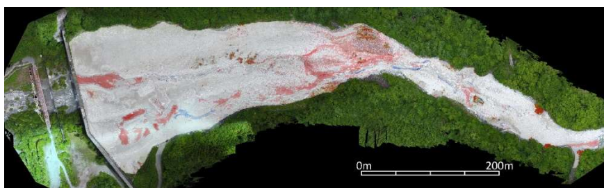
図 5 解析結果(オルソ画像と差分図による土砂流出状況)
