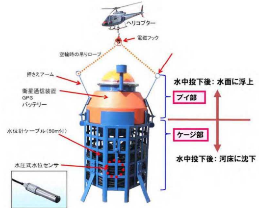
図1 投下型水位計の概要
