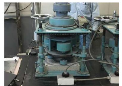
写真-1 耐摩耗試験機
